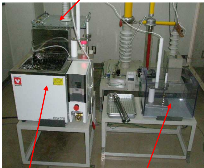
高温油槽 (RT~180°C) 高温絶縁油内での試験
