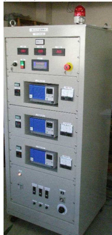
3系統試験制御装置の一例 (周波数可変: 40Hz~500Hzタイプ)
